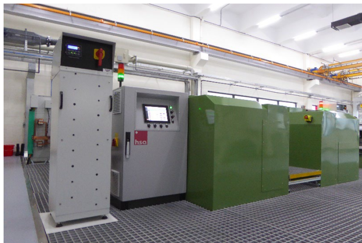
Chrombad (links mit 2 Gleichrichtern) und Entchromung
